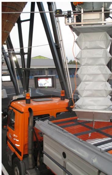
Grands silos ronds avec chargement entièrement automatisé et connexion au système de pesage
