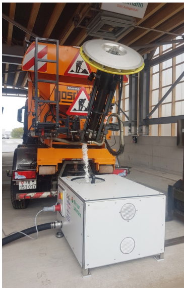
Installation de silos modulaires pour les matériaux d'épandage à Fribourg
