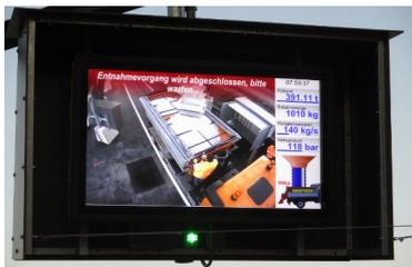
Überwachung des Verladevorgangs bequem von der Fahrerkabine mittels installiertem Bildschirm
