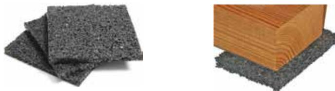
Gummigranulatunterlage, bildet einen Abstand zwischen Unterkonstruktion und Fundament, für eine gleichmässige Lastverteilung, gleicht kleine Unebenheiten aus, wirkt trittschallhemmend, nimmt keine Feuchtigkeit auf und wird unterlegt, wenn die Balken quer zur Wasserflussrichtung verlegt werden.
